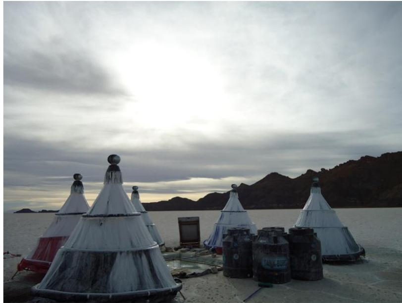
*Fig. 5. Conos en Proceso de Evaporación*
